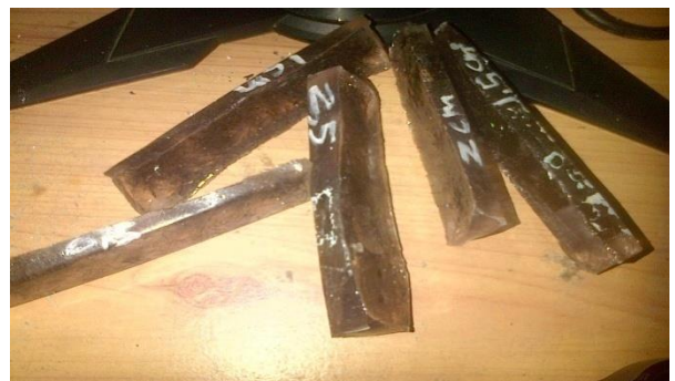
Gambar 2 Bentuk Spesimen Material komposit matriks polimer diperkuat serat ijuk
