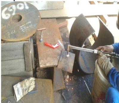
Gambar 2 : Pematongan Plat untuk benda Uji
