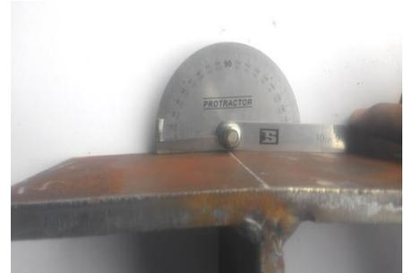
Gambar 10. Pengukuran Distorsi
