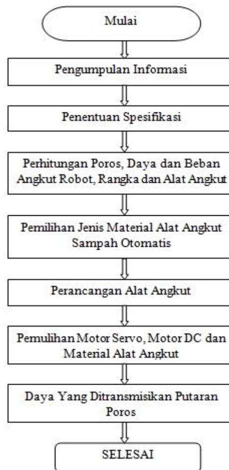
Gambar 3. Diagram Alir Perancangan Alat Angkut Sampah Otomatis.
