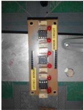
Gambar 6 Sensor Circuit dengan 6 potodioda led
