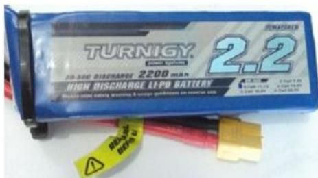
Gambar 7 baterai turnigy 2200 mah
