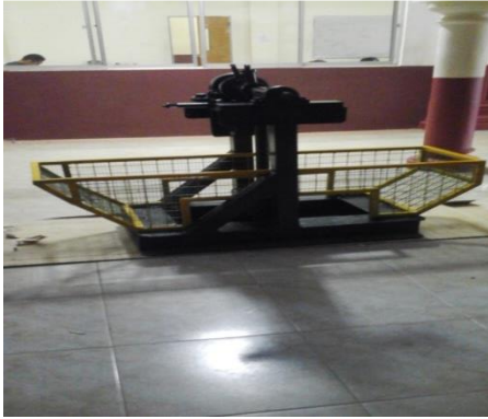
Gambar . 11. Hasil akhir membuat alat uji impak tipe charpy
