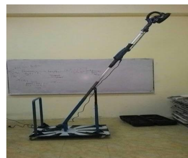
Gambar 26 Alat pembersih Multifungsi Dengan Menggunakan Mesin Polisher
