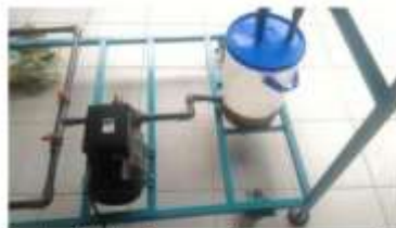
Gambar 24 Hasil penyambungan pompa dan tabung fluida.
