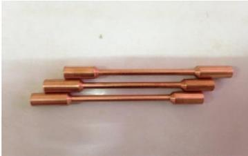
Gambar 5. Spesimen setelah pembubutan
