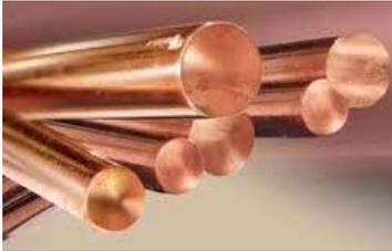
Gambar 4. Spesimen sebelum pembubutan
