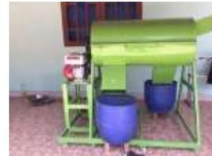
**Gambar 37.** Mesin pengurai sabut kelapa
