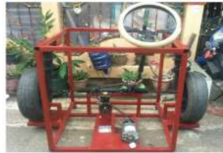
Gambar 4.21 Perakitan Alat Sistem Kemudi Power Steering
