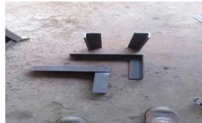
Gambar 20 Hasil pemotongan bagian motor support
