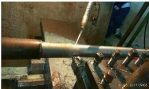
Gambar 4 Pembubutan 25mm menjadi 22mm sepanjang 130mm
