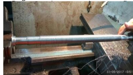
Gambar 6 Hasil Pembubutan akhir
