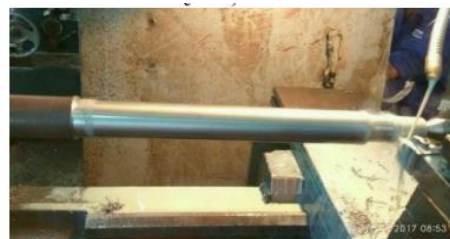
Gambar 3 Pembubutan 38 menjadi 25 mm
