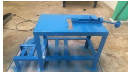
Gambar 28 Pengecatan sisi luar rangka
