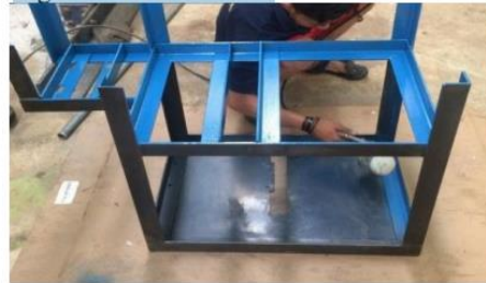
Gambar 26 Melakukan pengecatan bagian bawah rangka
