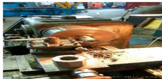
Gambar 8 Pulley 1 Pembubutan alur V
