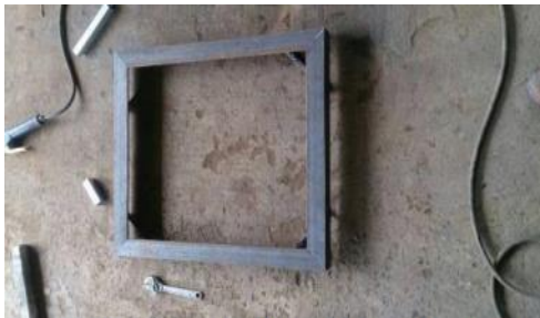
Gambar 17 Pembuatan sisi bawah rangka
