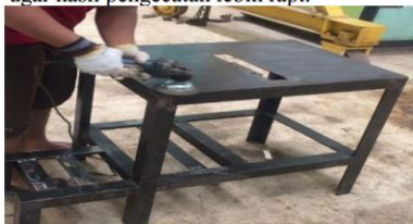
Gambar 25 Melakukan pembersihan seluruh sisi rangka
