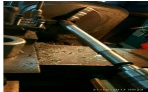
Gambar 5 Pembubutan 22mm menjadi 20mm sepanjang 50mm
