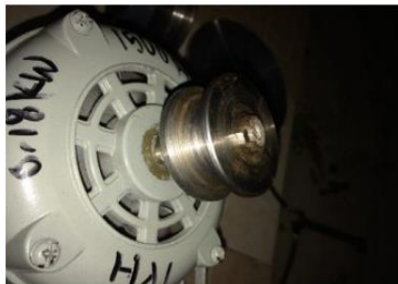
Gambar 13 Contoh hasil pembuatan kedudukan pasak
