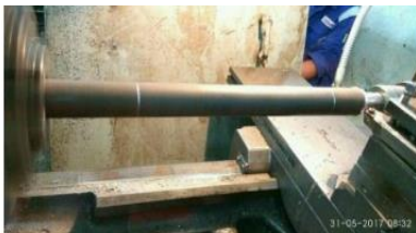
Gambar 2 Roundbar dipasang dichuck mesin bubut
