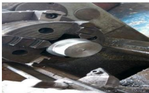
Gambar 7 Pulley 1 Pembubutan rata
