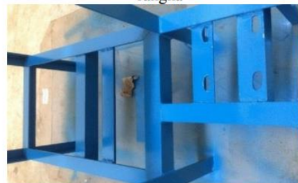
Gambar 27 Pengecatan sisi dalam rangka
