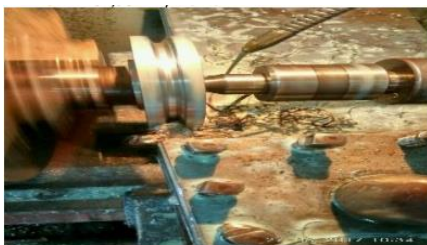
Gambar 10 Proses Pembubutan Pulley 2
