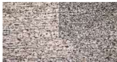
Sruktur Mikro 100x daerah Base Metal PWHT
