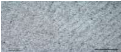
Struktur Mikro 500x daerah Weld metal PWHT
