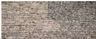
Struktur Mikro 100x daerah BasMetal Tanpa PWHT
