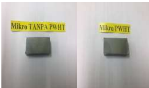
Gambar 5. Spesimen Uji Struktur mikro setelah di etsa
