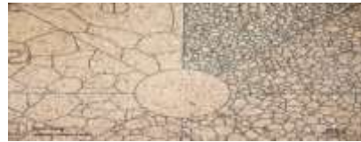
Struktur Mikro 100x daerah Weld Metal Tanpa PWHT
