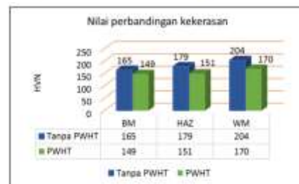
Gambar 23. Diagram hasil perbandingan uji kekerasan
