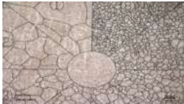
Struktur Mikro 100x daerah Weld Metal PWHT
