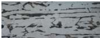
.Struktur Mikro 500x daerah Base Metal Tanpa PWHT
