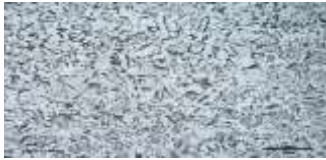
Struktur Mikro 500x daerah HAZ PWHT
