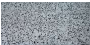
Struktur Mikro 100x daerah HAZ Tanpa PWHT
