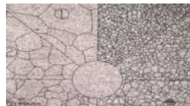
Struktur Mikro 100x daerah HAZ PWHT
