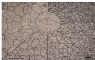
Struktur Mikro 100x daerah HAZ Tanpa PWHT
