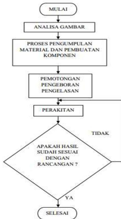
Gambar Diagram Proses Pembuatan Kompresor.
