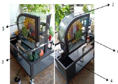
Gambar 3. Gambar alat uji prestasi turbin pelton
