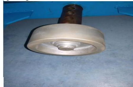
Gambar 4.2 Pemasangan upper base
