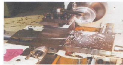
Gambar 3.8 Proses pembubutan upper base dan bottom base
