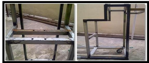
Gambar 5 Hasil perakitan kerangka untuk dudukan pompa dan penampung air di sisi tekan pompa.
