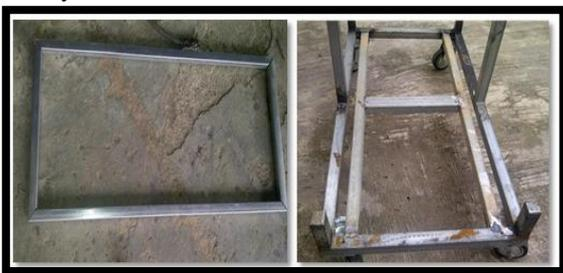
Gambar 4 Hasil dari perakitan kerangka untuk dudukan penampung air.
