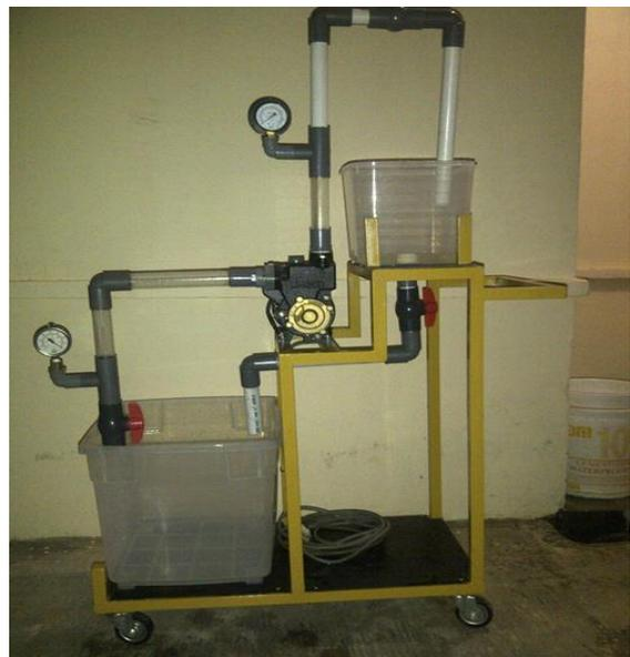
Gambar 13 Hasil akhir pembuatan simulator fenomena kavitasi pada instalasi pompa sentrifugal
