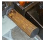
Hasil pemotongan bahan nipple menggunakan material stainless steel 316
