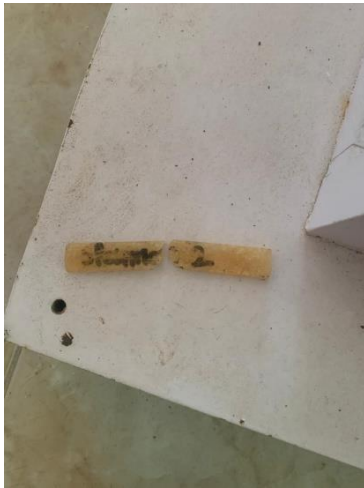
Gambar 4.5 Patahan/retakan pada spesimen
