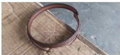
Gambar 9. Kerusakan seal hidrolik
