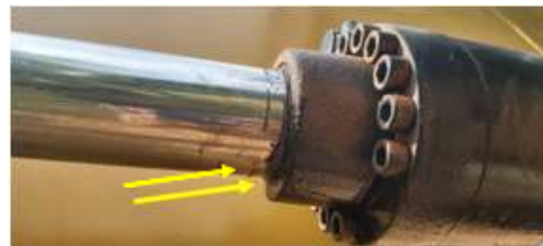
Gambar 3. Kebocoran oli pada silinder hidrolik
