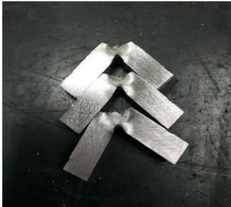
**Gambar 10** *Speciment set pertama setelah uji impact*
