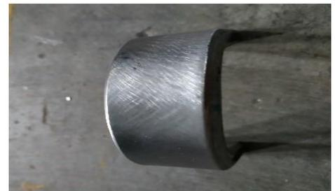
**Gambar 7 Spesimen kedua setelah uji lengkung**
