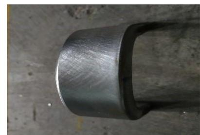
**Gambar 9 Spesimen ke empat setelah uji lengkung**
