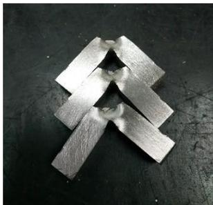
**Gambar 11** *Speciment set kedua setelah uji impact*
