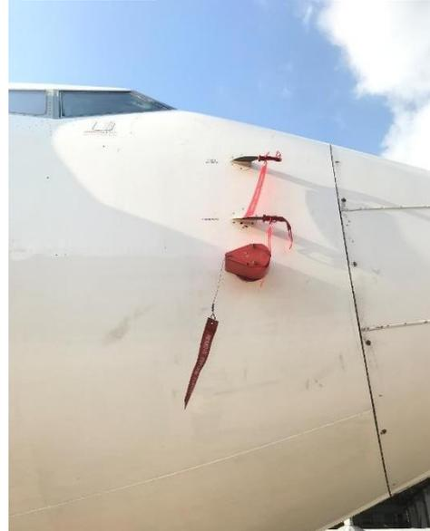
Gambar 3. Pitot probe dengan menggunakan cover
