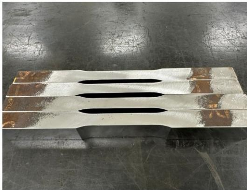
Gambar 6 Benda uji setelah proses permesinan untuk PROD-4-1
