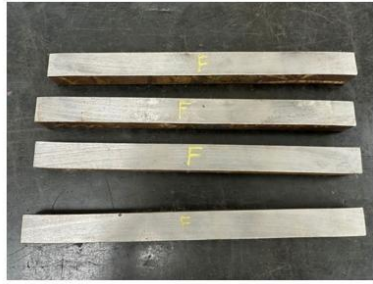
Gambar 5 Bentuk benda uji setelah flattening untuk PROD-4-:
