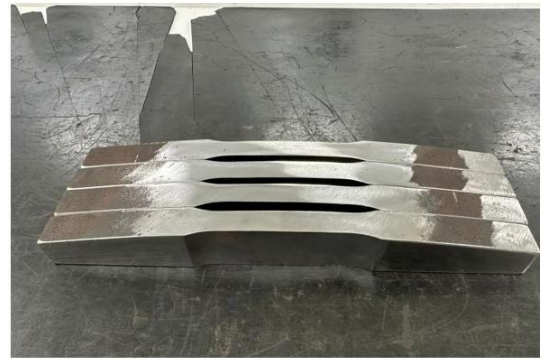
Gambar 9 Benda uji setelah permesinan untuk PROD-4-13 WF
