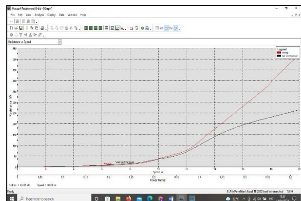
Gambar 2. Grafik Perbandingan antara kecepatan dengan nilai tahanan kapal
