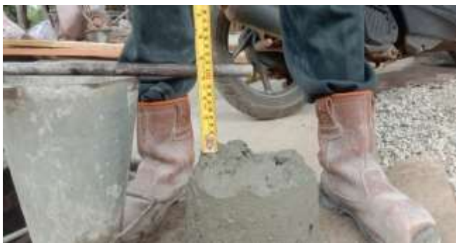
Gambar 3. Foto dokumentasi tes slump dengan ukuran 12 cm di Kawasan Mangsang Indah RT 02 RW 24 Ke. Mangsang (sumber: dokumentasi konsultan pengawas)
