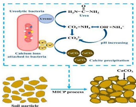
Gambar 1. Proses MICP pad Bio-concrete dengan peran bakteri
