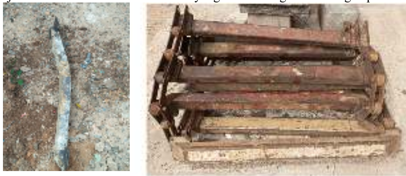
Gambar 4. Track shoe yang bengkok dan berkarat
