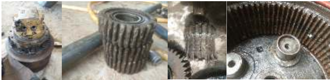
Gambar 6. Roda gigi Hydraulic Motor Track yang sudah rusak
