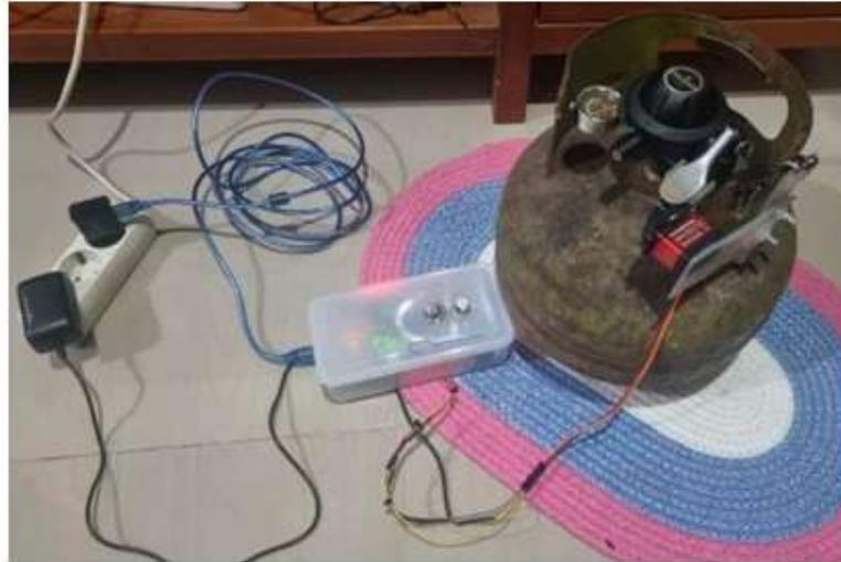
Gambar 6. Pemasangan Alat Pendeteksi Kebocoran Gas dan pada Tabung Gas LPG
