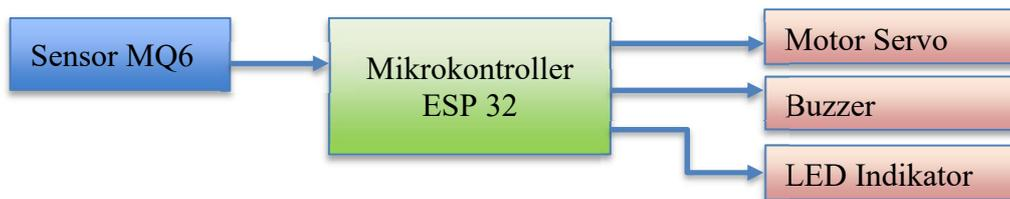
Gambar1. Blok Diagram Perancangan Sistem Pendeteksi Kebocoran Gas
