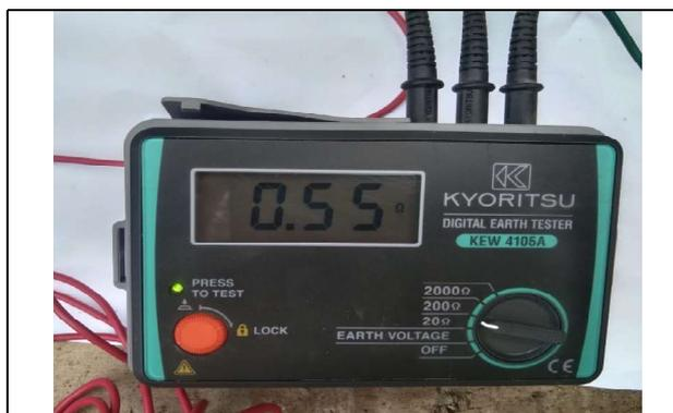
Gambar Hasil Pengukuran Elektroda gabungan E1, E2 dan E3
