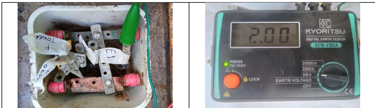
Gambar Hasil Pengukuran Elektroda 1
