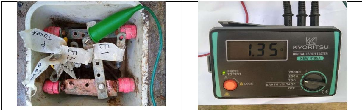
Gambar Hasil Pengukuran Elektroda 3
