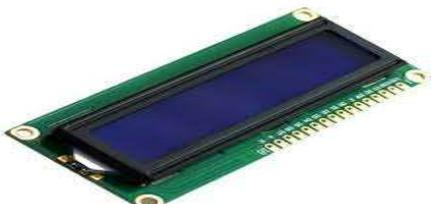
Gambar 4. LCD 16x2
