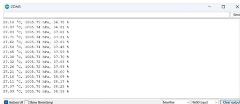
Gambar 7. Pengujian Sensor BME280
