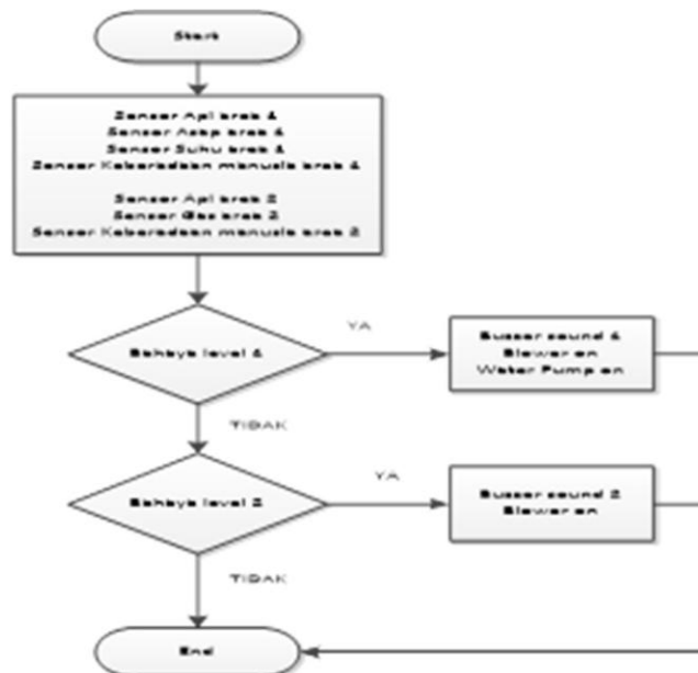
Gambar 3. Flowchart Pemrograman Actuator
