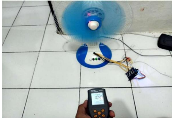
Gambar 4.3 Pengujian Kecepatan Blower (Kipas Angin Sebagai Pengganti Blower)
